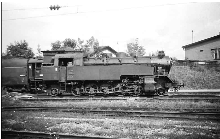
Nákladní vlaky mezi Zručí nad Sázavou a Světlou nad Sázavou dopravovala ve druhé polovině šedesátých let lokomotiva 524.1 přidělená do Ledče nad Sázavou. Typické zde byly zejména lokomotivy s výše uloženou osou kotle a s vodočističem Voříšek-Stěpán, vyráběné v libeňské lokomotivce v době druhé světové války. V Havlíčkově Brodu byly tři a každá jiná: 524.1139 s původním komínem, 524.1138 s plochým komínem a nejhezčí 524.1137 s kulatým komínem a usměrňovacími plechy.
